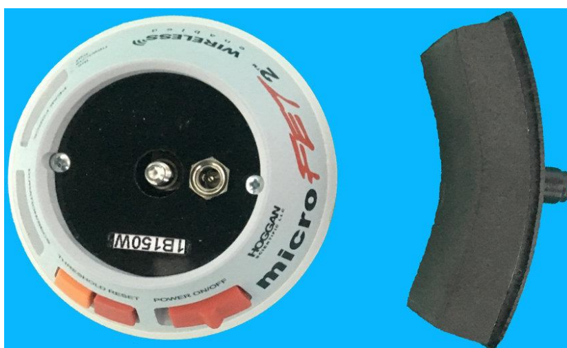
Ryc. 6. Dynamometr elektroniczny MicroFet 2 wraz ze specjalną nakładką [Özbek, Armangil i Bilgin 2018].
