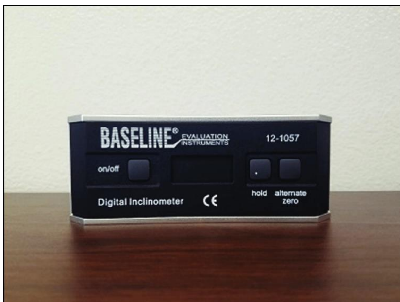
Ryc. 5. Cyfrowy inklinometr Baseline [Cheatham i Stull 2018].
