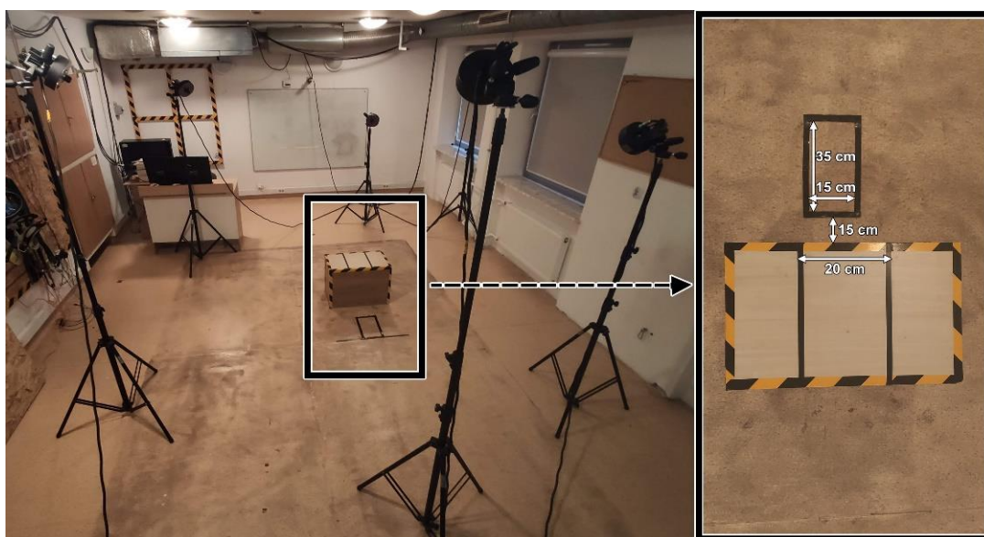
Rycina 4. Ustawienie kamer oraz stanowiska do lądowania jednonóż po zeskoku pionowym.
